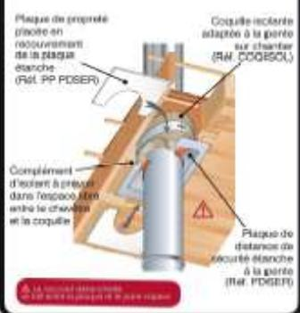
Plaque de protection provisoire en recouvrement de la plaque étanche (RM PP PDSER)
